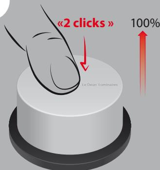
Intensité lumineuse directement à 100% en appuyant 2 fois rapidement sur le bouton rotatif
