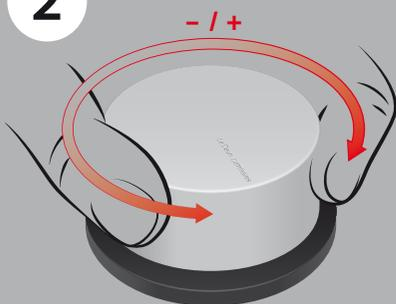
Varié l'intensité lumineuse en tournant le bouton rotatif dans le sens des aiguilles d'une montre pour augmenter la luminosité et dans le sens inverse pour diminuer l'intensité lumineuse
